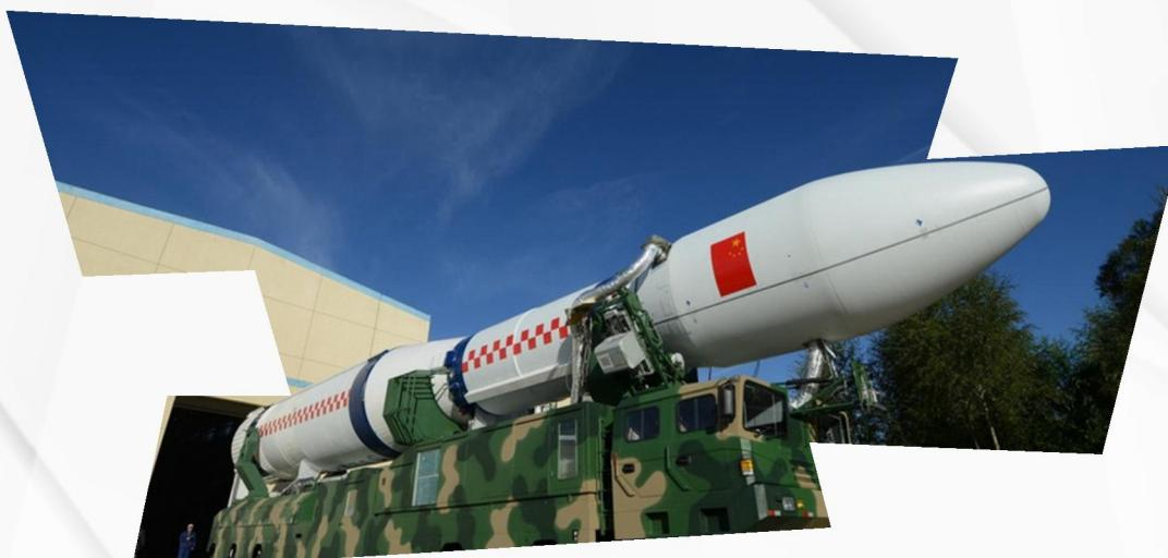
我國的長征二號系列、長征三號系列、長征四號系列火箭使用偏二甲肼與四氧化二氮作為推進劑。這種推進劑組合能在常溫下保持液態，無需低溫存儲，有效降低成本；二者接觸無需點火即可劇烈燃燒，簡化了火箭發動機的設計難度。這些特性使得它們成為最適合運載火箭使用的推進劑。
